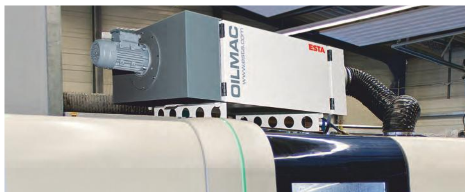
OILMAC 800 na obrabiarce CNC Aspirowane opary mgły olejowej nie tylko poprawiają jakość powietrza w przestrzeni produkcyjnej ale zmniejszają straty emulsji stosowanej w procesie.
