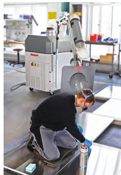
VACUMAT z ramieniem odciągowym do eliminacji zapachów w procesie klejenia.
